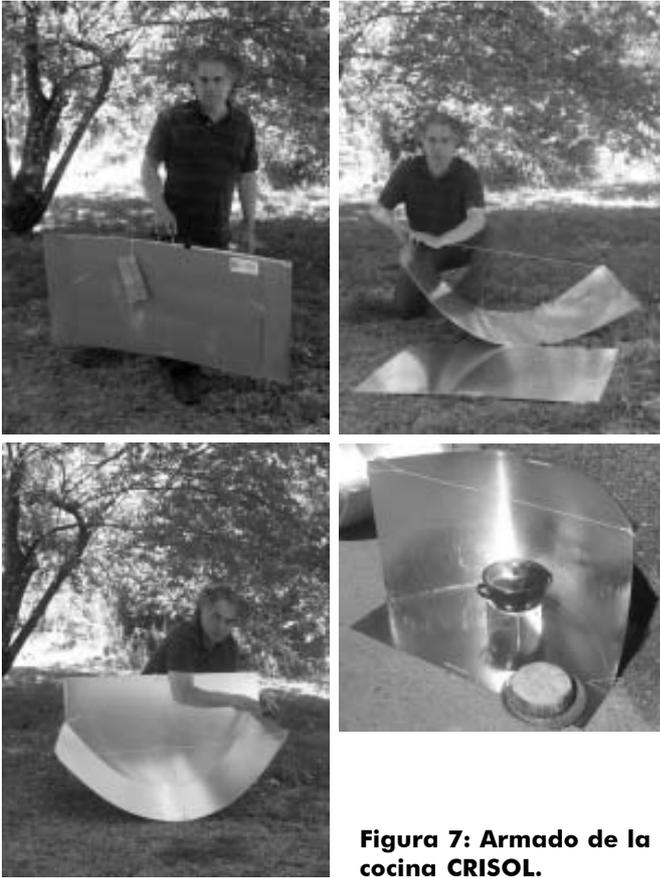
Figura 7: Armado de la cocina CRISOL.
