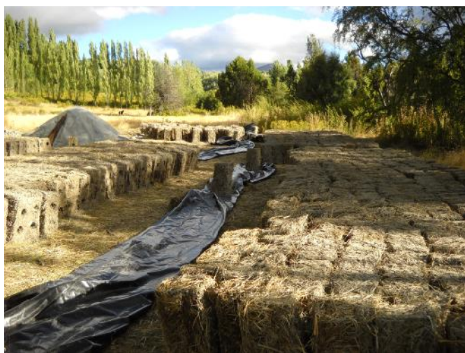
Figura 1. Bloques de paja y arcilla secándose en el ambiente exterior.
