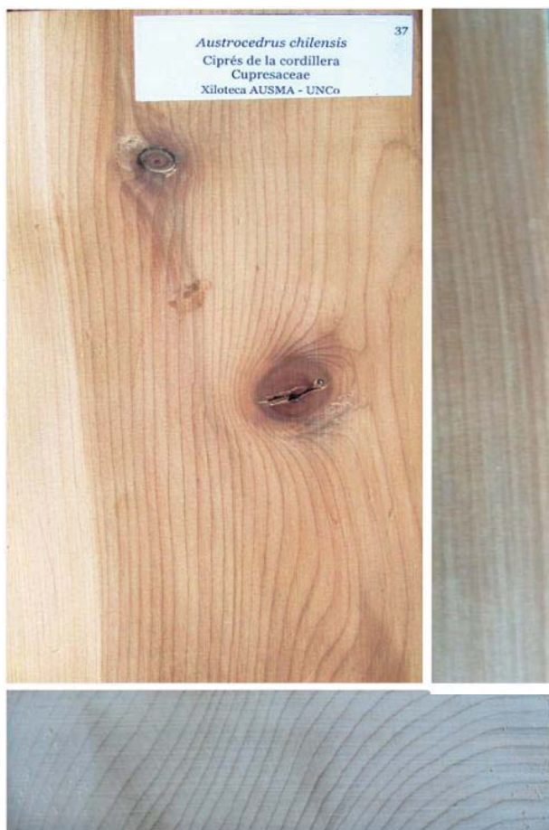
Figura 5. Muestra de Austrocedrus chilensis "Ciprés de la cordillera". Cara tangencial (izquierda), radial (derecha) y transversal (abajo).
