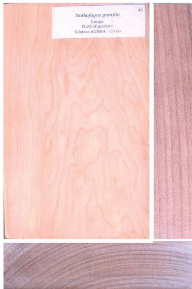
Figura 4. Muestra de Nothofagus pumilio "Lenga". Cara tangencial (izquierda), radial (derecha) y transversal (abajo).
