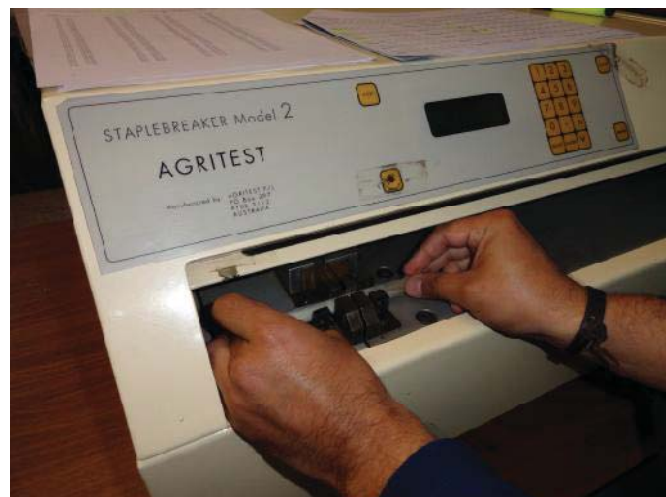
Midiendo el largo de una mecha de lana en el Laboratorio de Fibras Textiles.
